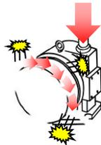
La tolleranza della velocità di spinta può cambiare dipendentemente dall'inerzia dovuta al peso delle attrezzature di bloccaggio che si possono applicare alla tavola. Pertanto si consiglia di controllare, ad ogni nuovo ciclo di lavorazione con nuove attrezzature di bloccaggio, che la tavola si posizioni nella posizione desiderata.
