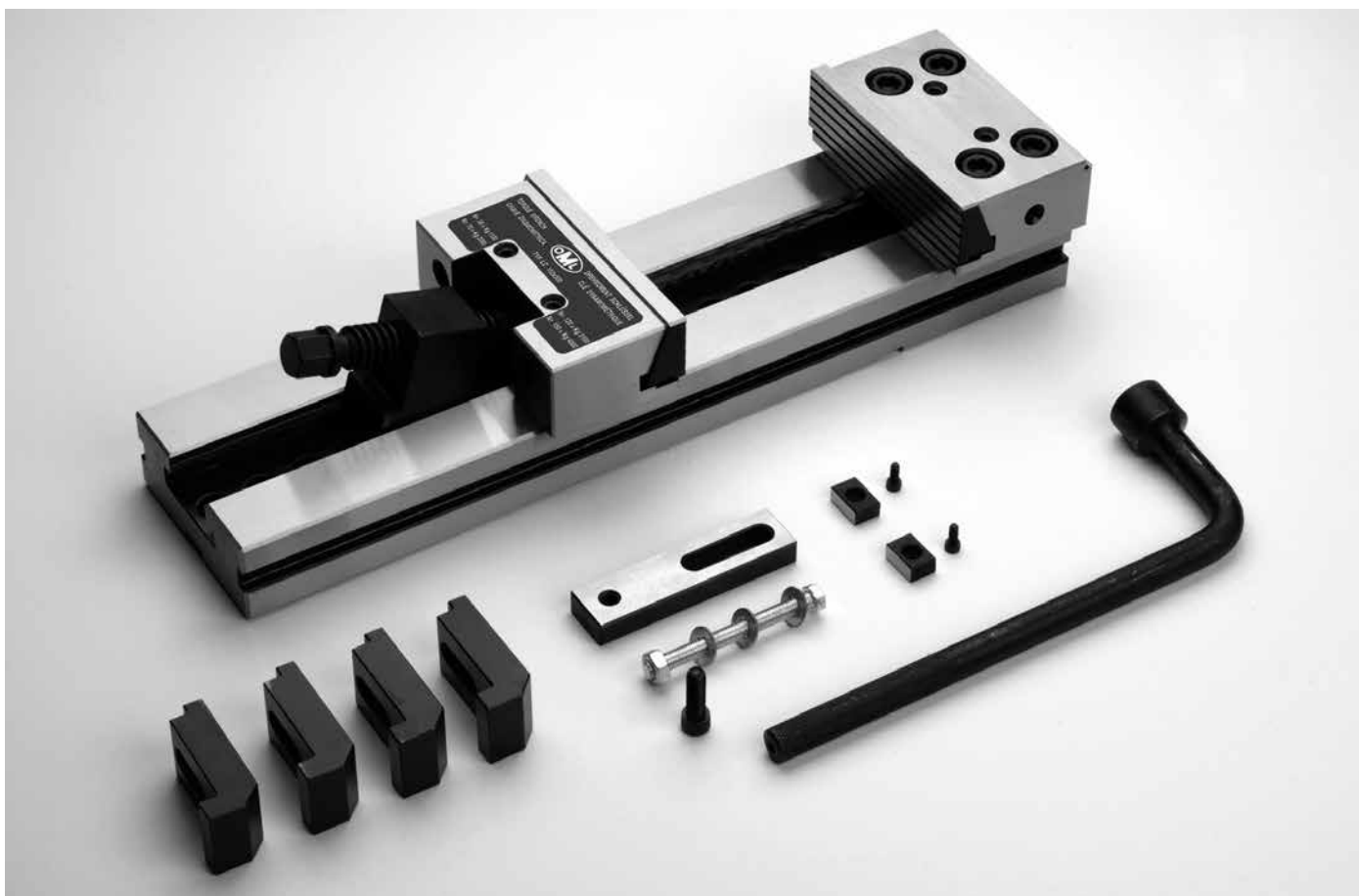
Attrezzatura di bloccaggio LC con: chiave a pipa, ganascia guidata (a richiesta ganascia oscillante), piastrina di fermo laterale, coppia chiavette di posizionamento h6 a scelta, carter protezione vite, 4 staffe di fissaggio, cassa imballo in cartone.
